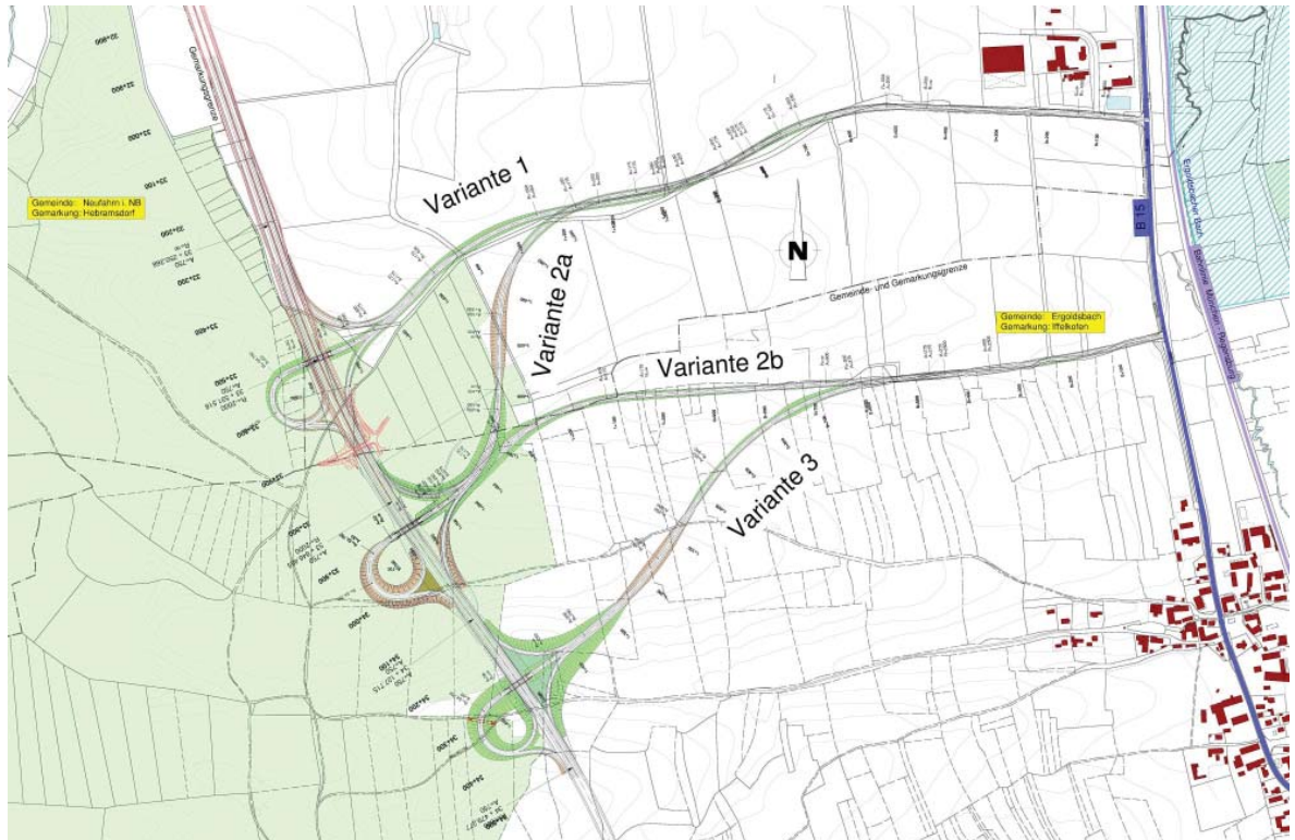
Übersicht Varianten 1, 2a, 2b und 3 - Anschlussstelle B 15n mit Zubringer zur B 15 alt
