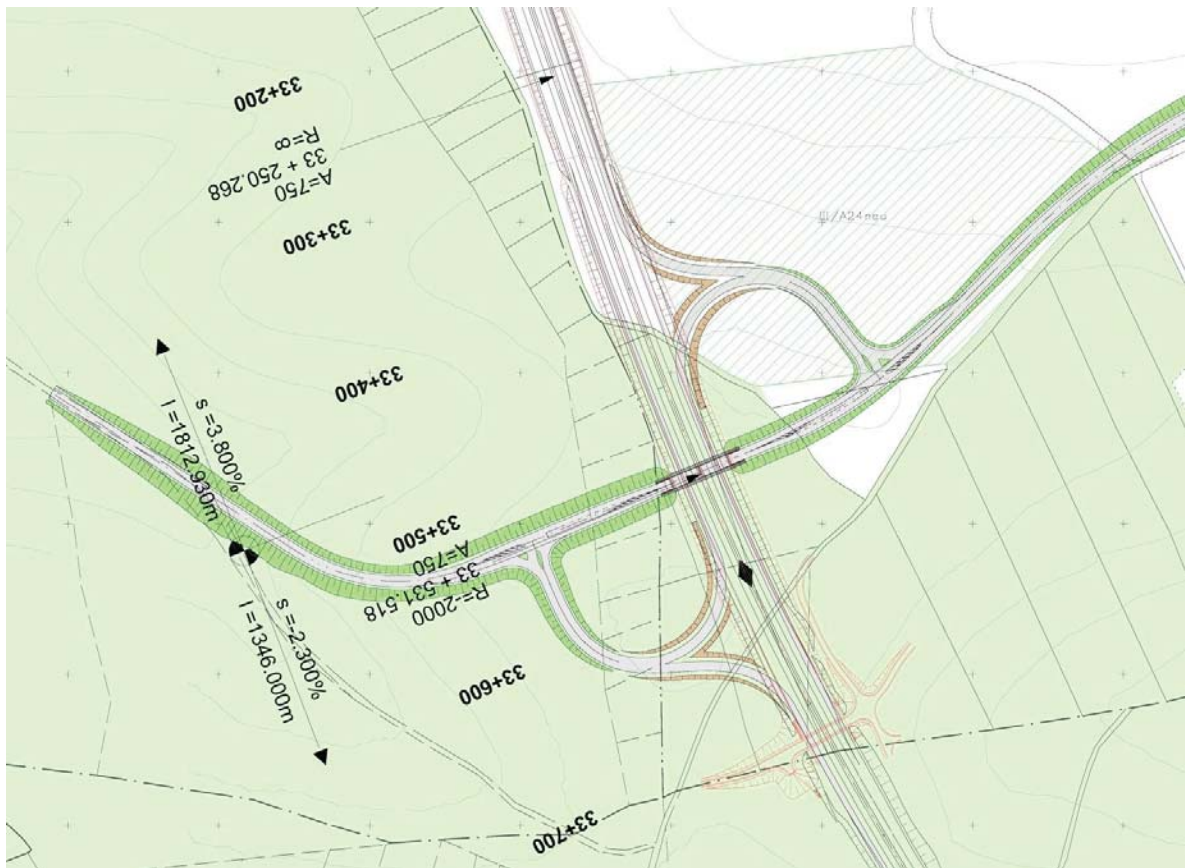
Anschlussvariante 5: Diagonales halbes Kleeblatt
