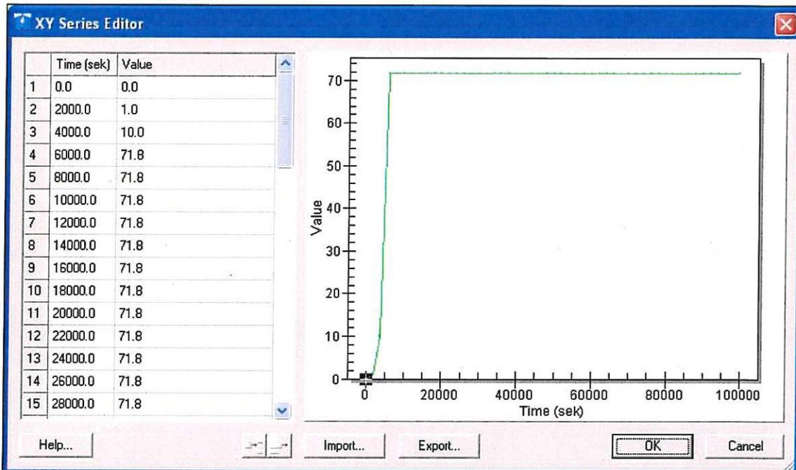
Bild 4 Zuflussganglinie für die Hengersberger Ohe zur stationären Berechnung mit  $71,8 \text{ m}^3/\text{s}$  (HQ 100+20%)
