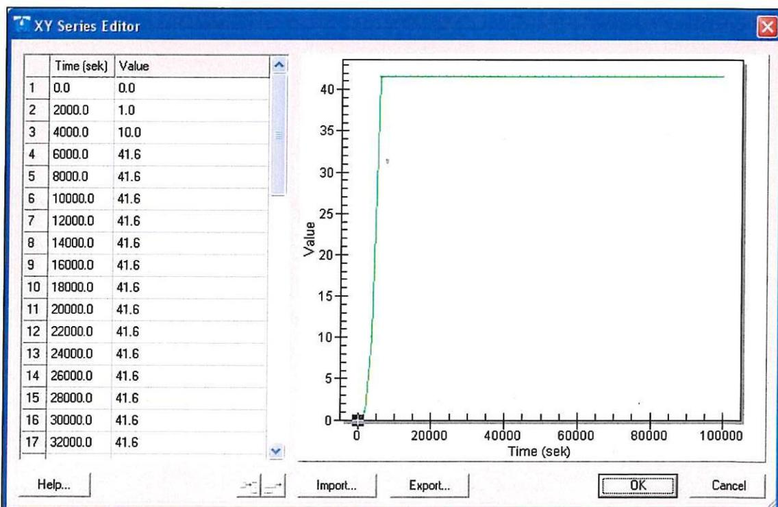
Bild 5 Zuflussganglinie für die Hengersberger Ohe zur stationären Berechnung mit  $41,6 \text{ m}^3/\text{s}$  (HQ 5)
