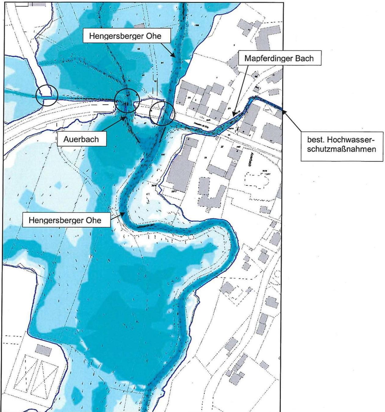
Bild 10 IST-Zustand – maßgebender Hochwasserabfluss HQ 100 + 20 % (Planausschnitt)
