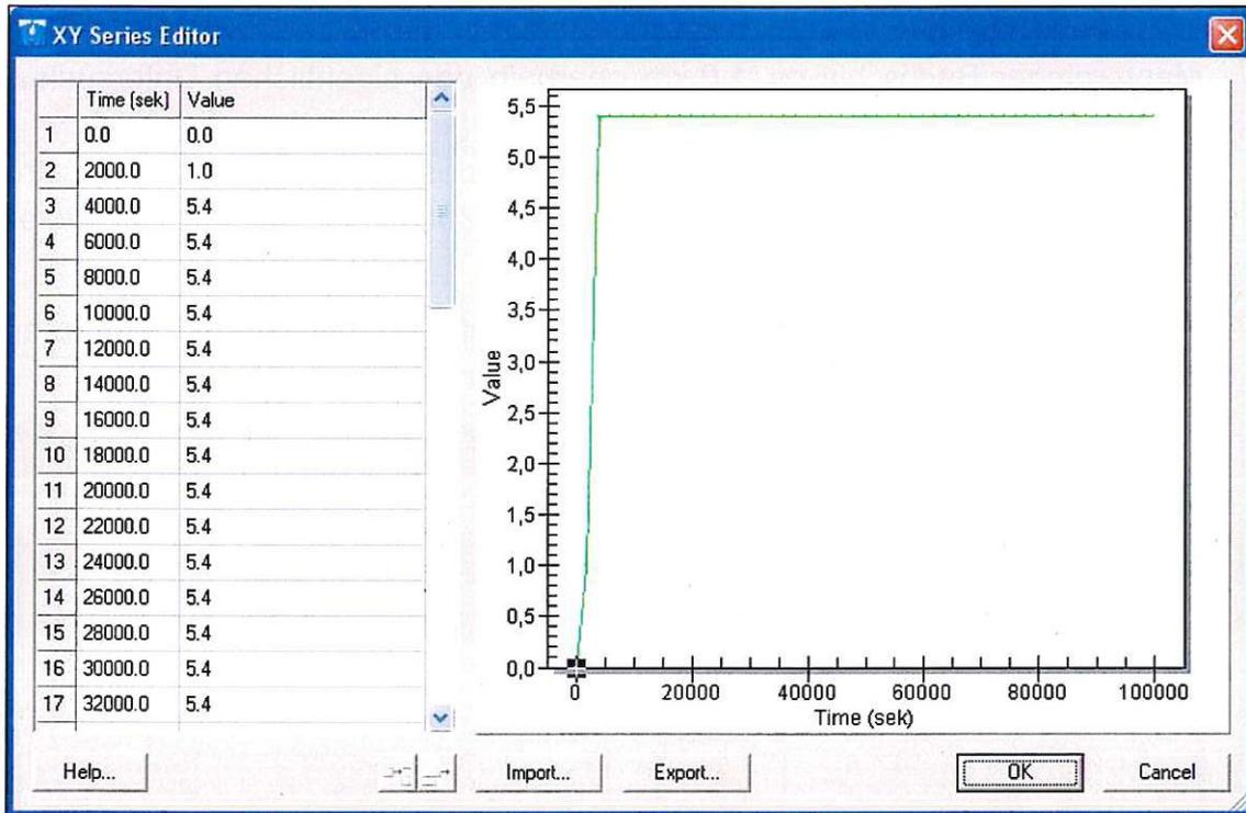
Bild 6 Zuflussganglinie für den Mapferdinger Bach zur stationären Berechnung mit 5,4 m³/s (HQ 5)
