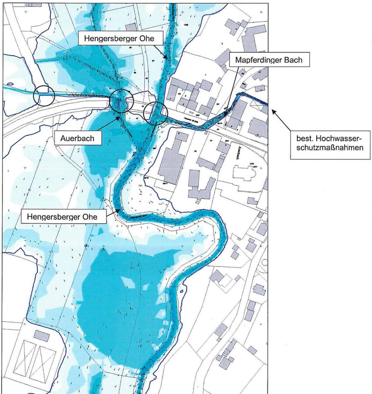
Bild 9 IST-Zustand – maßgebender Hochwasserabfluss HQ 5 (Planausschnitt)
