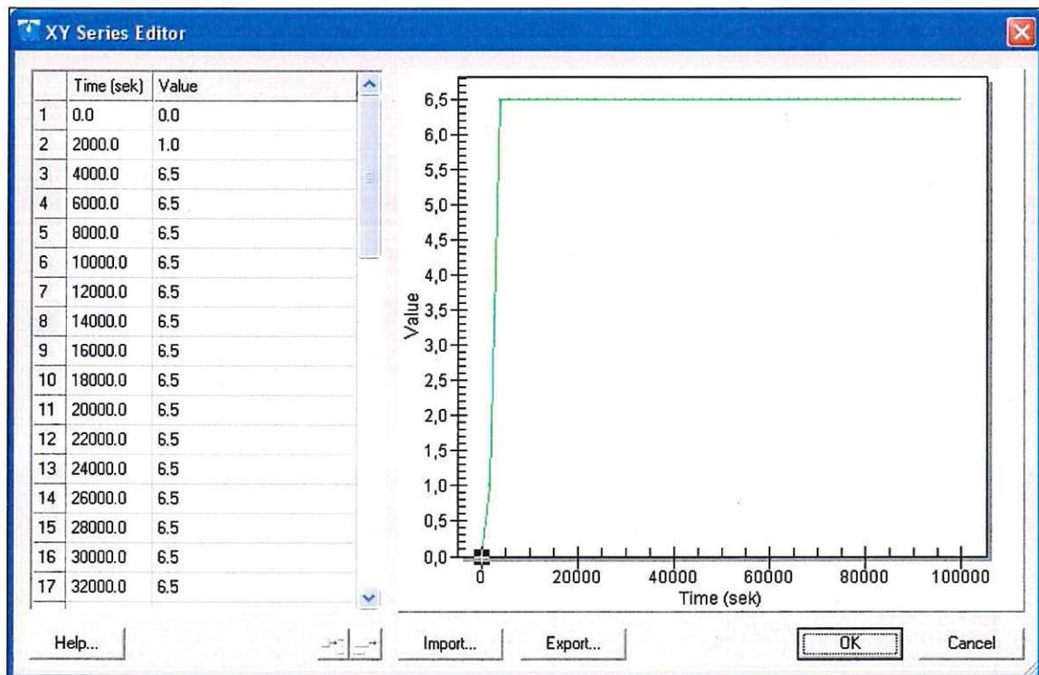
Bild 7 Zuflussganglinie für den Mapferdinger Bach zur stationären Berechnung mit 6,5 m³/s (HQ 100+20%)
